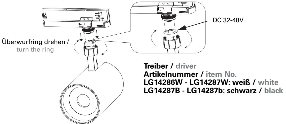
**Linsen und / oder Gehäusering wechseln / removing the lens or trim ring:**
