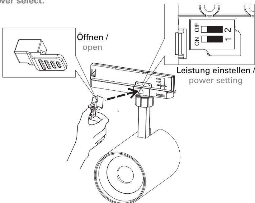
**Treiber wechseln / removing the driver:**
